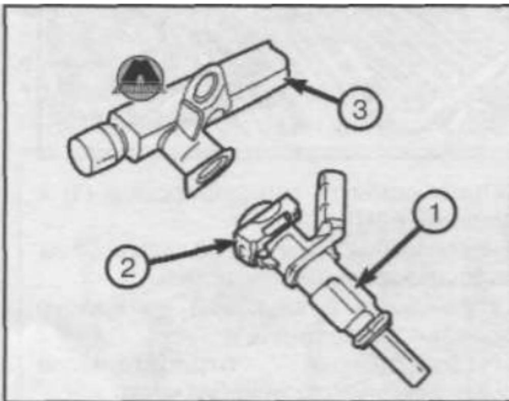
2. Установить зажим (2) топливной форсунки.
