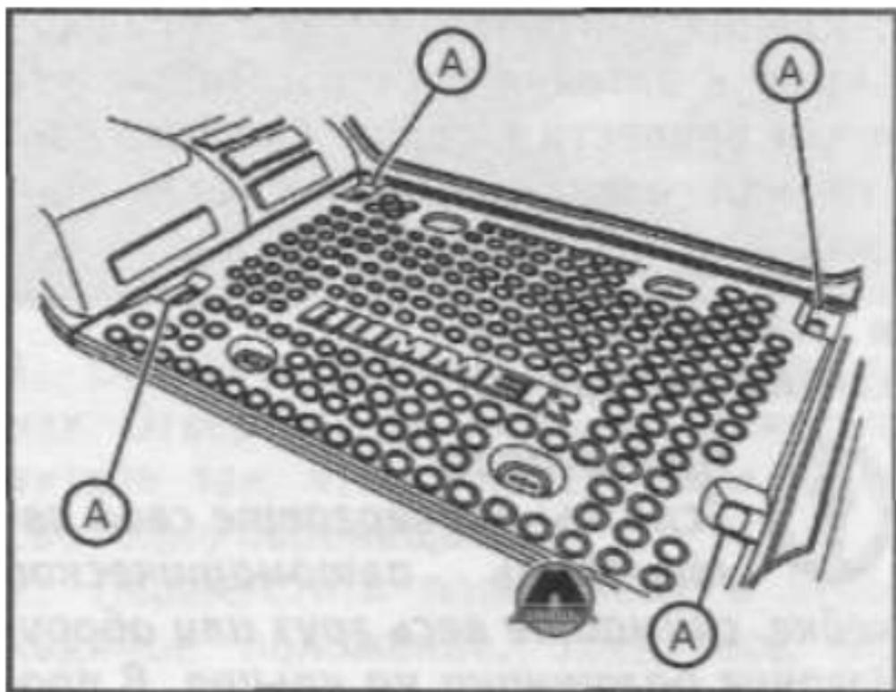
Ваш автомобиль также оснащен четырьмя дренажными отверстиями (А), расположенными под резиновым покрытием в багажном отделении.
