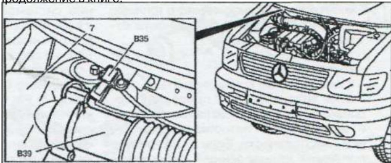
**Датчик давления сжатого воздуха:** 7 – корпус воздушного фильтра; В35 – датчик давления сжатого воздуха; В39 – массовый расходомер воздуха
