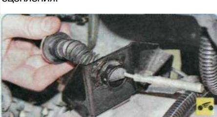
12. Отверните поводок от наконечника троса, извлеките направляющую втулку оболочки троса из отверстия на кронштейне коробки передач и снимите трос с автомобиля, вытягивая его из отверстия в щите передка.
