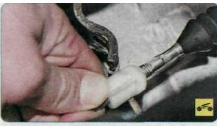
11. Потянув наконечник троса вперед по направлению движения автомобиля, выведите наконечник из паза вилки выключения сцепления.
