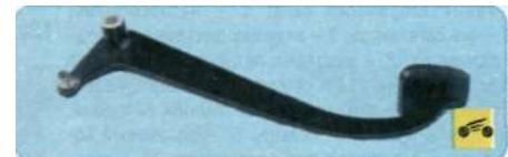
1. Снимите педаль сцепления (см. «Замена и регулировка троса привода сцепления», с. 142).
