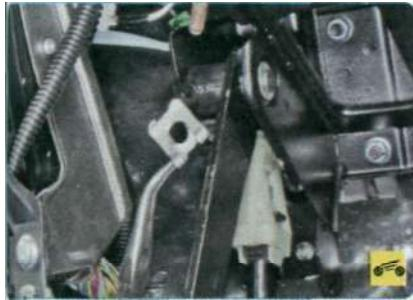
...и снимите стопорную скобу с оси педали сцепления.
