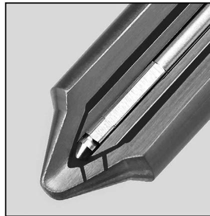
Поскольку игла в распылителе ничем не уплотняется, некоторое количество топлива просачивается между иглой и корпусом форсунки и попадает в полость, где расположена пружина (13). Если топливо не будет удаляться из этой полости, игла распылителя может потерять возможность перемещаться и форсунка окажется «запертой». Для удаления просочившегося топлива служит дренажная система (10).
