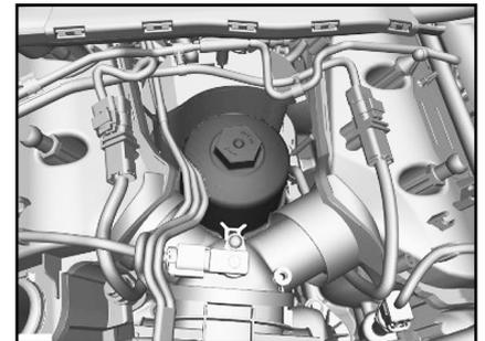
5. Снимите фильтрующий элемент с крышки. Удалите в отходы сам фильтрующий элемент и уплотнительное кольцо крышки.
