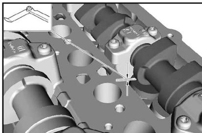
6. Проверьте зазоры в клапанах во всех остальных цилиндрах двигателя.
