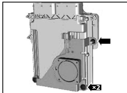
7. Отверните три гайки крепления и затем снимите модуль управления двигателем с кронштейна.
