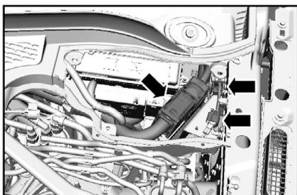
4. Отверните два болта крепления и затем снимите модуль управления двигателем в сборе с кронштейном.
