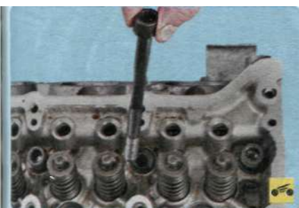
12 ...и окончательно выверните болты крепления головки. Выньте болты.
