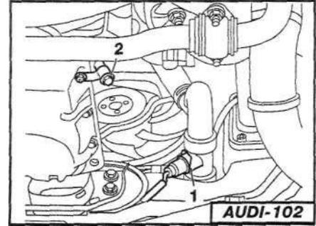
**Бензиновые двигатели:** Снимите с радиатора нижний шланг. Для этого на присоединительном штуцере стяните вбок зажим (см. стрелку на рис. AUDI-097), затем снимите шланг. Соберите охлаждающую жидкость.
