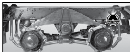
Подвеска MAN TGA с трапециевидными рессорами
