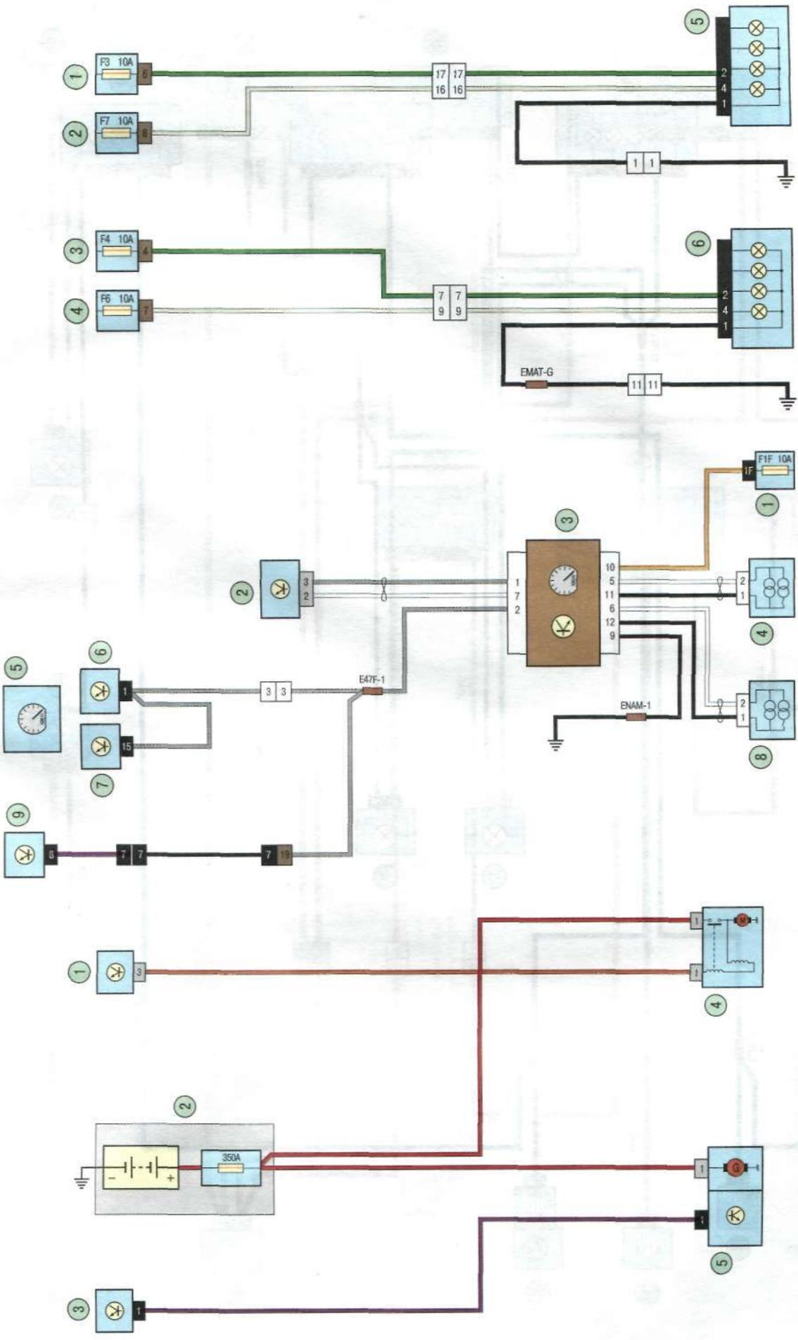
Схема 10. Скорость движения автомобиля: 1 – монтажный блок в салоне автомобиля; 2 – монтажный блок в моторном отсеке; 3 – датчик частоты вращения колеса; 4 – датчик частоты вращения левого переднего колеса; 5 – комбинация приборов; 6 – головное устройство аудиосистемы; 7 – ЭБУ навигационной системы; 8 – датчик частоты вращения правого переднего колеса; 9 – люк крыши с электроприводом
