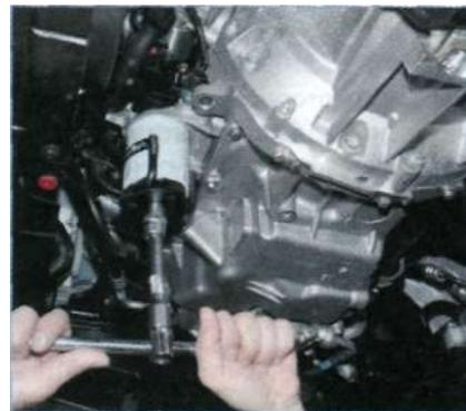
**...ослабляем затяжку фильтра съемником.**
