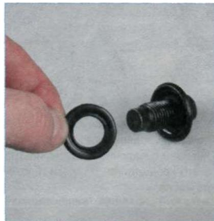
**Снимаем резиновое уплотнительное кольцо пробки...**
