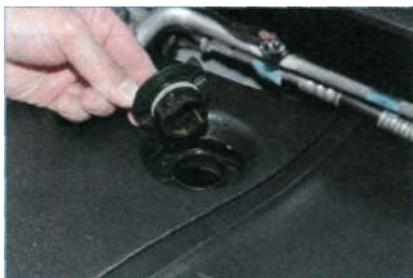
**...поворачиваем против часовой стрелки и снимаем крышку маслозаливной горловины.**
