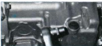
**Головкой «на 13» ослабляем затяжку пробки сливного отверстия поддона картера.**
