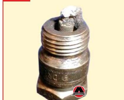
Свеча зажигания, изображенная на фото №8, имеет электрод, покрытый золотыми отложениями. При этом цвет отложений не играет решающей роли. Причина такого нароста – сгорание масла вследствие износа или залипания маслосъемных поршневых колец. На двигателе наблюдается повышенный расход масла, из выхлопной трубы валит синий дым. Процедура замены поршневых колец описывается в главе «Механическая часть двигателя».
