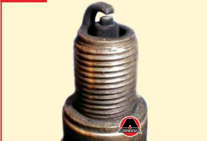
Свеча, изображенная на фото №2, вывернута из двигателя с повышенным расходом топлива. Центральный электрод такой свечи покрыт бархатисто-черным нагаром. Причинами этого могут быть богатая воздушно-топливная смесь (неправильная регулировка карбюратора или неисправность системы электронного впрыска), засорение воздушного фильтра.
