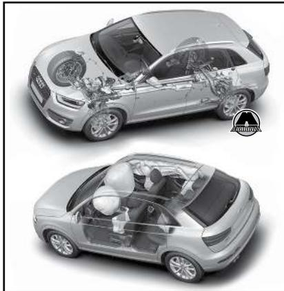
Н высоте безоп сность водителя и п сс жиров. Кузов Audi Q3, выполненный из листового мет лл переменной толщины и ст льных дет лей горячей формовки, отлич ется высокой жесткостью и прочностью. Н личие полного комплект подушек безоп сности и ремней с предн тжителями позволило модели во время кр ш-тестов, проведенных в 2011 году нез висимой орг низ цией Euro NCAP, пок з ть н ивысший уровень безоп сности и з служить пять звезд.
