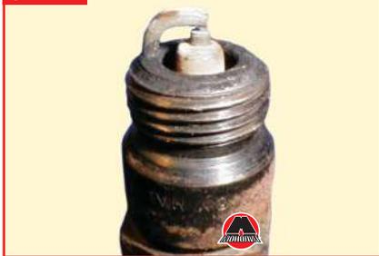
На фото №3 изображена свеча из двигателя, топливоздушная смесь которого в отличие от предыдущего случая слишком обеднена. Цвет электрода такой свечи зажигания от светло-серого до белого. При работе на бедной смеси эффективная мощность двигателя падает, а процесс сгорания происходит с нарушениями, сопровождаемыми неравномерной работой двигателя. Изд-во "Monolith"
