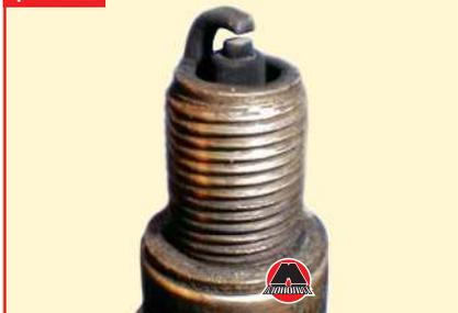
Свеча, изображенная на фото №2, вывернута из двигателя с повышенным расходом топлива. Центральный электрод такой свечи покрыт бархатисто-черным нагаром. Причиной этого могут быть богатая воздушно-топливная смесь (неправильная регулировка карбюратора или неисправность системы электронного впрыска), засорение воздушного фильтра.
