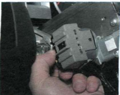
Нажимаем на фиксатор колодки...
