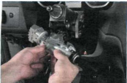
Снимаем выключатель зажигания.
