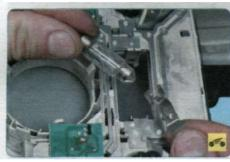
12. ...и снимите лампу общего освещения передней части салона.
