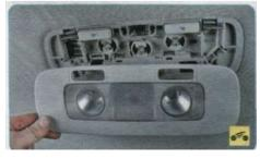
16. ...и снимите рассеиватель плафона освещения мест задних пассажиров.
