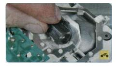
6. Поверните против часовой стрелки патрон в сборе с лампой...
