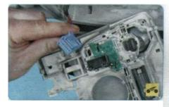
5. Отсоедините колодку жгута проводов от плафона освещения мест водителя и переднего пассажира и снимите плафон.
