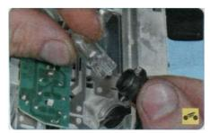
8. Извлеките из патрона лампу освещения места водителя.
