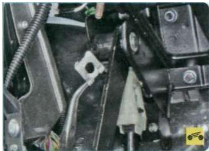
...и снимите стопорную скобу с оси педали сцепления.
