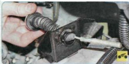
12. Отверните поводок от наконечника троса, извлеките направляющую втулку оболочки троса из отверстия на кронштейне коробки передач и снимите трос с автомобиля, вытягивая его из отверстия в щите передка.
