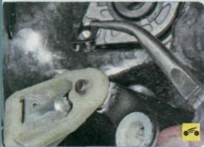
3. „и снимите стопор наконечника троса привода сцепления.
