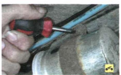
4. Выверните винт крепления хомута и снимите топливный фильтр.
