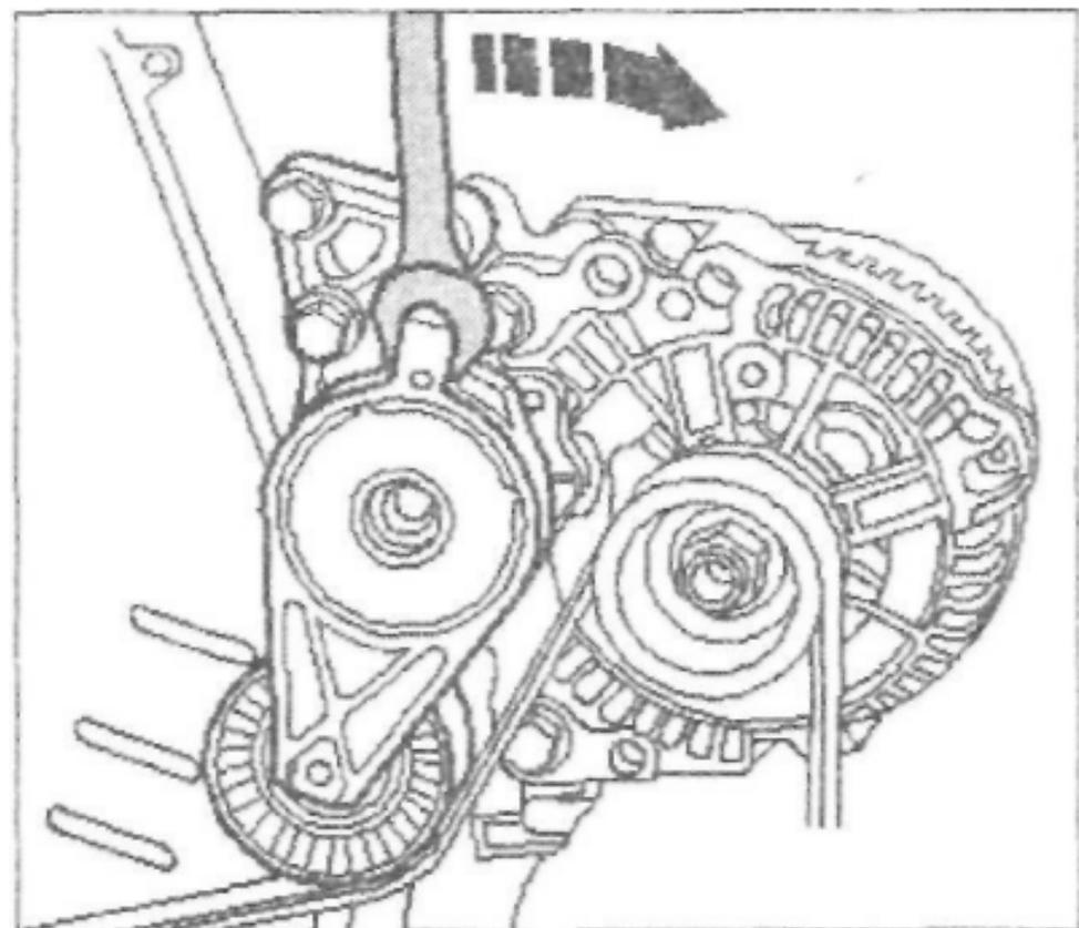
Зафиксировать натяжитель фиксатором-Т10060А-.
