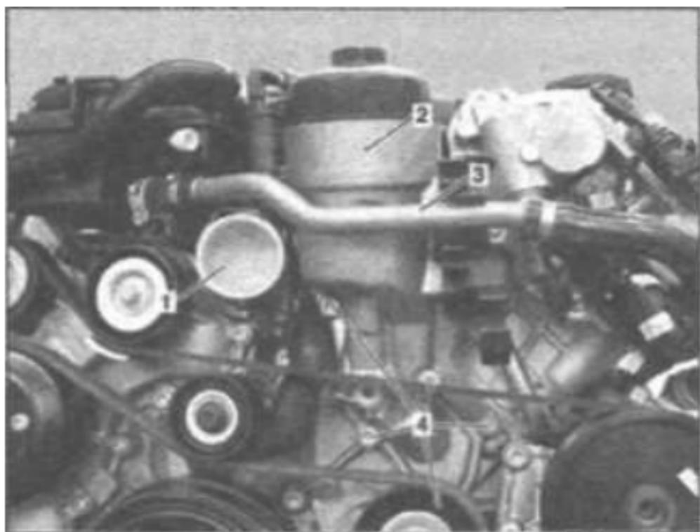
1. Корпус регулятора температуры охлаждающей жидкости
