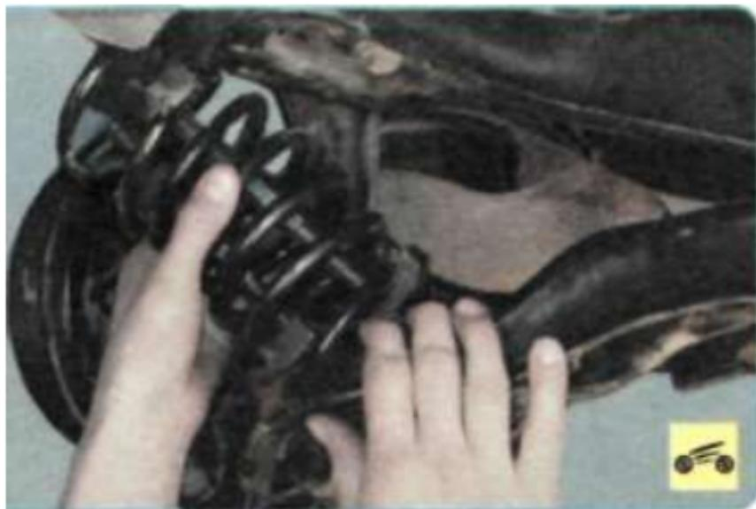
1 Снимите пружину задней подвески (см «Замена пружины задней подвески», с. 154).
