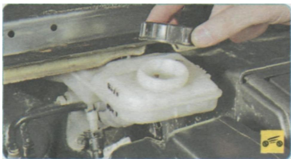
1. Снимите пробку бачка главного тормозного цилиндра и откачайте тормозную жидкость из секции бачка главного тормозного цилиндра, питающей ...
