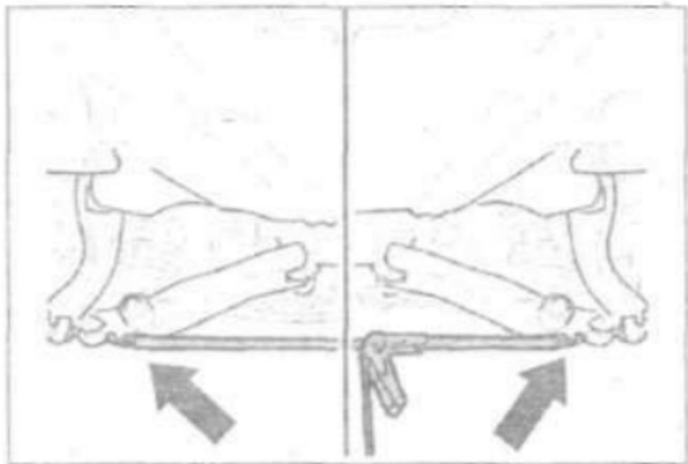
Закрепите рычаги управления. Используйте фиксирующие хомуты. Амортизаторы слегка сжаты. Снимите: винт амортизатора, амортизаторы с рычагов управления.
