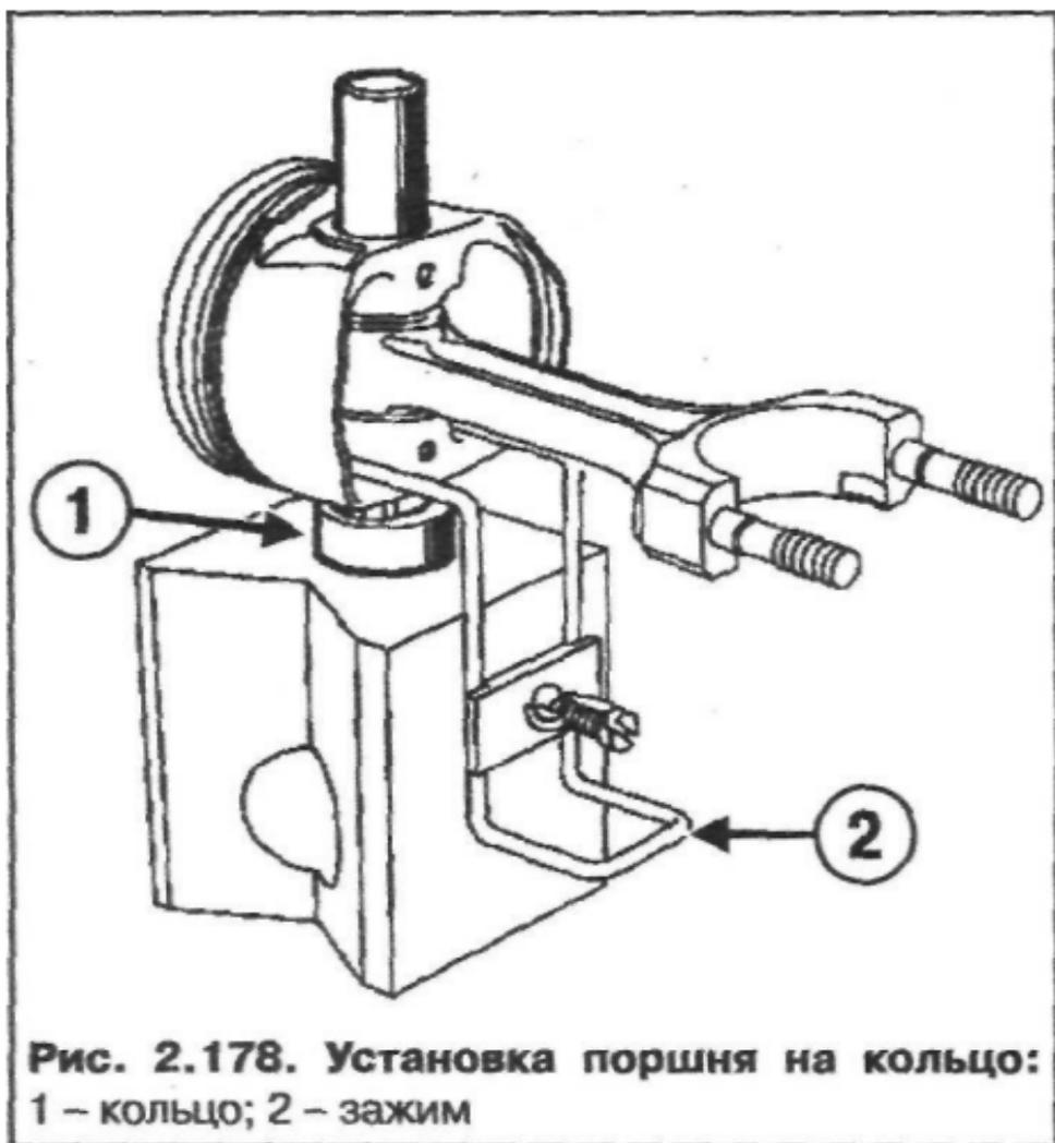
Рис. 2.178. Установка поршня на кольцо:
