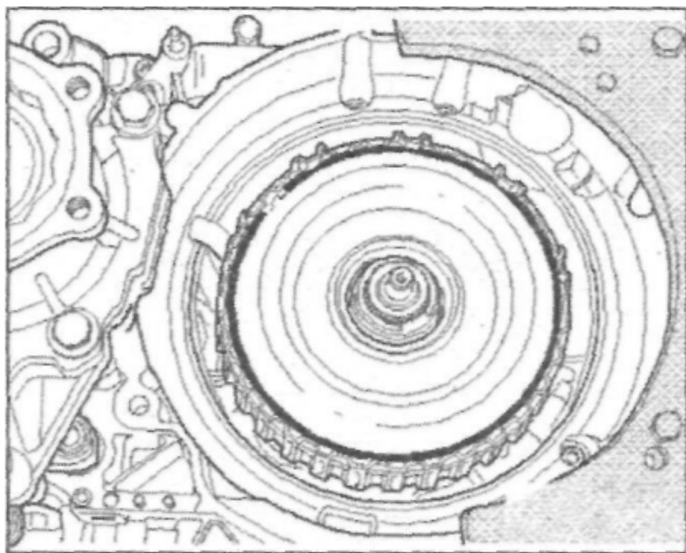
Снять стопорное кольцо -стрелка-. Для сведения: Это стопорное кольцо позднее при ...
